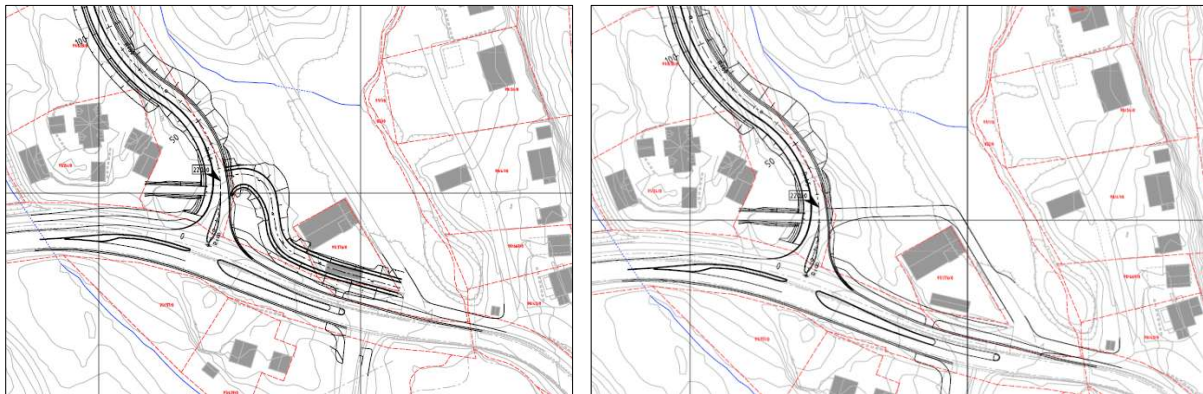
Figur 18. To løsninger som har blitt vurdert i planprosessen, men som etter dialog med Statens vegvesen har blitt forkastet til fordel for løsningen i planforslaget. Begge løsningene medfører bilkjøring på eksisterende gang-/sykkelveg for å komme frem til Osloveien 264-270.
