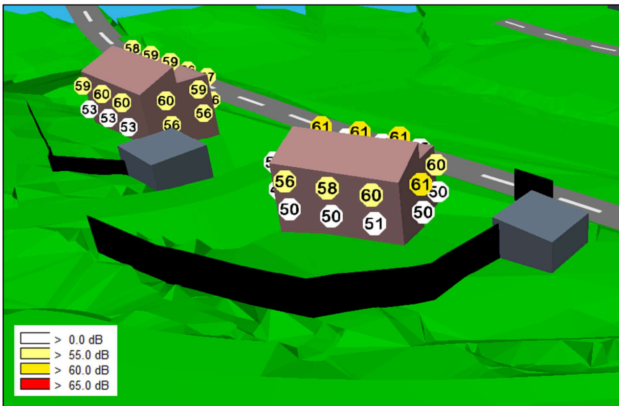
Figur 4-2: Fasadenivåer for L_{den} , innfallende lydtryknivå. Tomannsboliger med boligtypen kalt Skråvika. Sett fra sør. Forslag til støyskjermer vist i svart.
